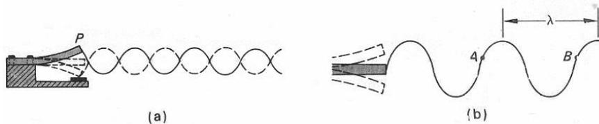
Figura 2.3 (a) Producción y propagación de una onda transversal. (b) Longitud de onda.
